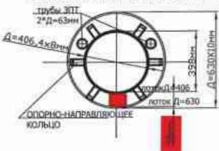
При этом неизбежны погрешности, и довольно существенные, связанные с износом пластиковых наконечников опорно-направляющих колец.
