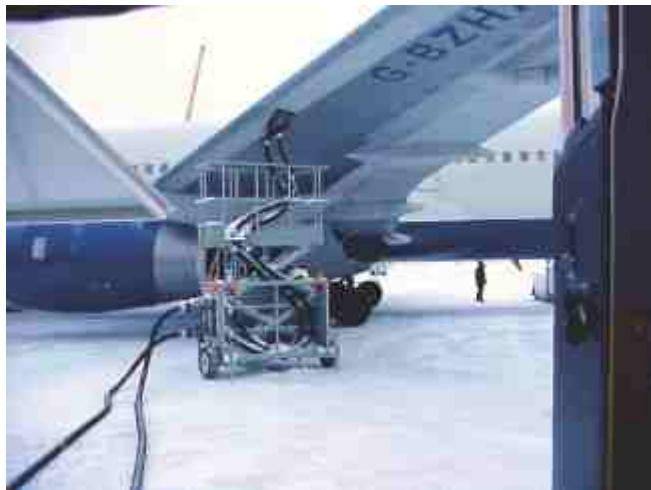
Рис. 2. Процесс заправки с подъемной подкатной тележки
