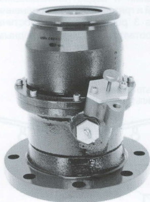
Рис. 1. Автоматический клапан гидрантного колодца модели 61654D 6 x 4 по нормам API 1584 – 3e Издание, производство фирмы Carter
