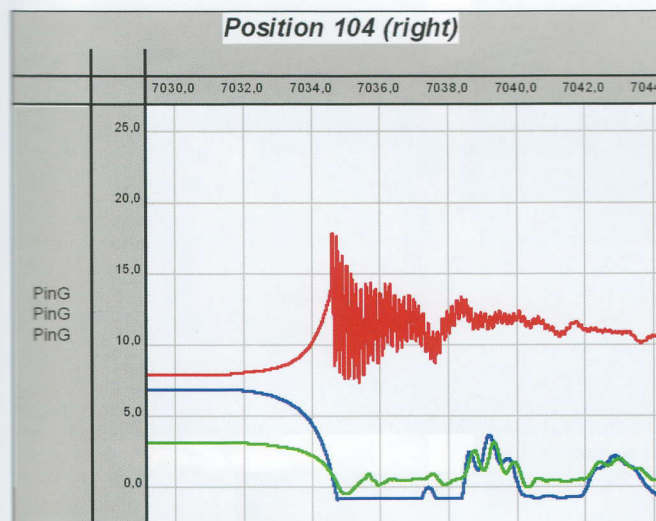
Рис. 5. Гидравлический удар в «закольцованной» системе ЦЗС при закрытии клапана гидрантного колодца (стоянка 104 правая). Время закрытия клапана 3 сек. Красный - замер на клапане гидрантного колодца, голубой - замер в сервисном колодце, зеленый - замер на наконечнике заправочного агрегата.
