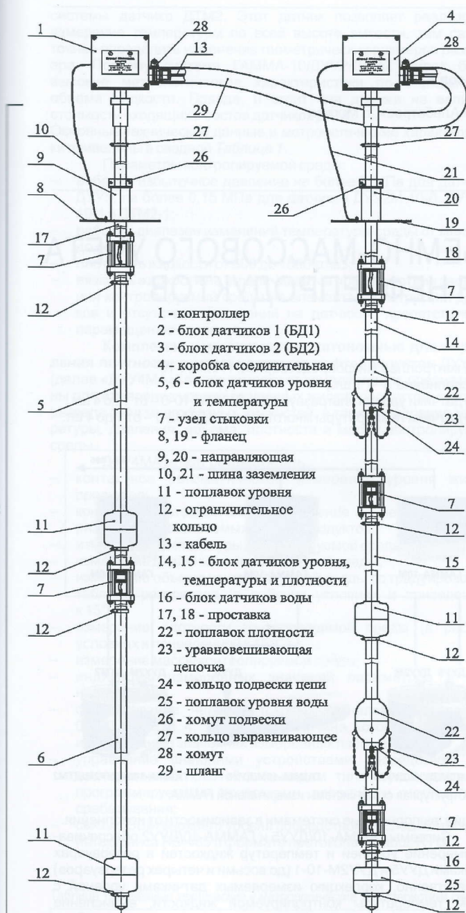
Рис. 1 Общий вид ППП измерительной системы «Струна»
