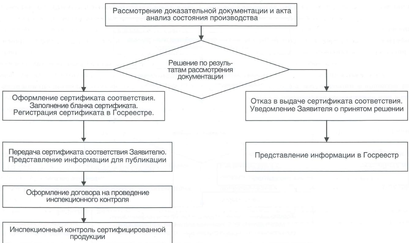
Рисунок 3. Блок-схема «Управление процедурами завершения сертификации, выдачи сертификата соответствия»
