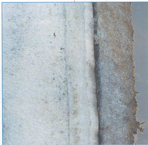
Фото. 3. Сечение полипропиленового многослойного элемента
