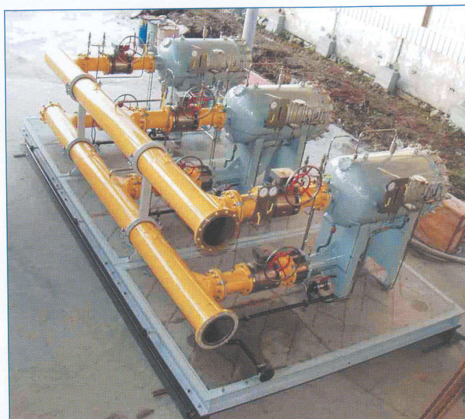
Фото 1. Блок фильтров на 1500 м³/час
